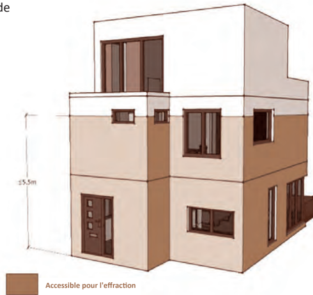
Figure 5.29 : Accessibilité pour l'effraction dans les structures de séparation extérieures selon la NEN 5087.
